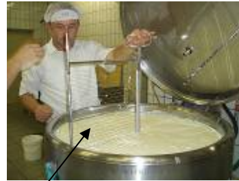
Gallerte wird mit Hilfe der Käseharfe geschnitten und anschließend verzogen
