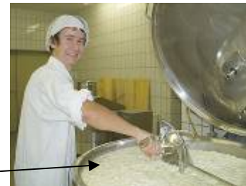
Gallerte wird mit Hilfe der Käseharfe geschnitten und anschließend verzogen
