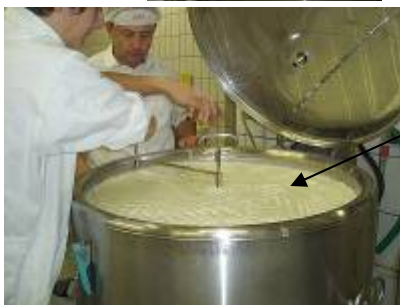
Gallerte wird mit Hilfe der Käseharfe geschnitten und anschließend verzogen
